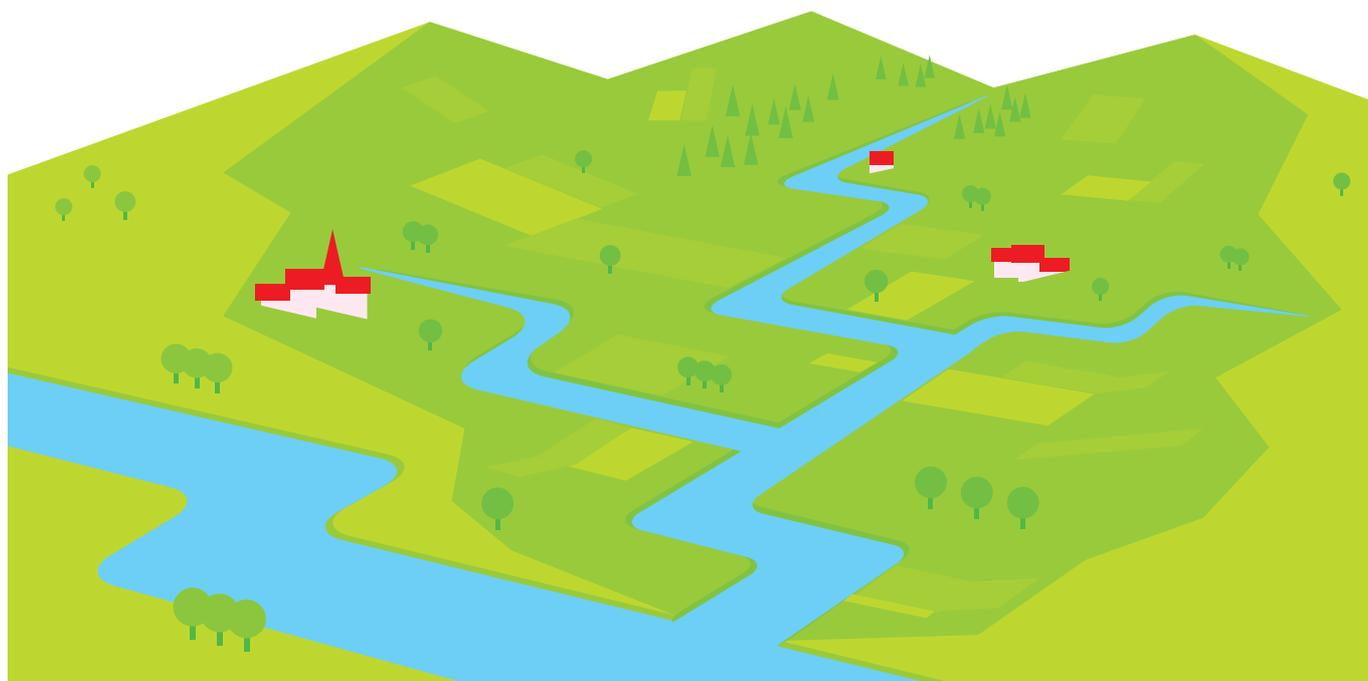
Figure 23 : Schéma d'un bassin versant
